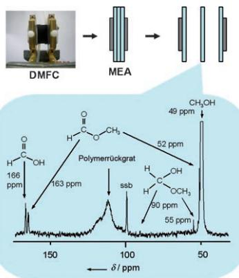
**Methanoldurchtritt** und Reaktionszwischenstufen in einer Direktmethanolbrennstoffzelle (DMFC) wurden durch  $^2\text{D}$ - und  $^{13}\text{C}$ -MAS-NMR-Spektroskopie untersucht. Eine Membranelektrodeneinheit (MEA) bestehend aus drei Schichten einer Polymerelektrolytmembran (PEM) wurde für die DMFC verwendet, wobei der mittlere PEM-Film separiert und zur NMR-Analyse herangezogen wurde (siehe Bild).
