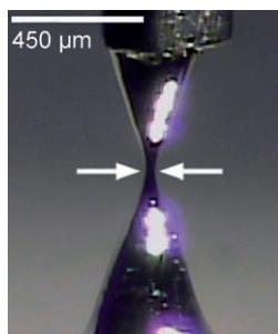
**Mikroelektroden** aus der Titelverbindung erweisen sich als ideal für die Messung der elektrischen Eigenschaften selbstorganisierter Monoschichten. Im Bild ist gezeigt, wie sich das EGaIn zwischen einer Metallnadel und einer Ag-Oberfläche (nicht erkennbar) teilt. Aus dem Teil oberhalb der weißen Pfeile wird später die EGaIn-Elektrode.
